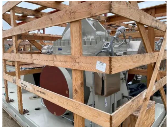
Sulzer 24x24x29 AZ HSB Centrifugal Pump
