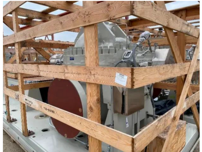
Sulzer 24x24x29 AZ HSB Centrifugal Pump
